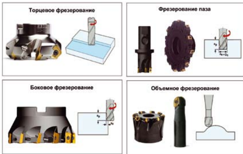
Рис. 1. Традиционные методы фрезерования и применяемый инструмент
