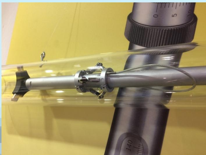
На основе стандартной конструкции мы производим инструменты, обладающие такой точностью, которой не смог добиться еще никто. Устройства отличаются чрезвычайной легкостью. Они снабжаются треножками с повышенным уровнем жесткости обеспечивающей практически автоматическую центровку инструмента в больших отверстиях. Поставляемые инструменты могут использоваться для работы как в вертикальной, так и в горизонтальной плоскости.
