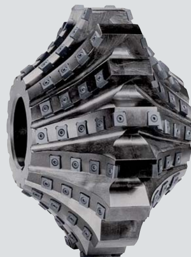
Zahnform-Scheibenfräser m 50, E \sphericalangle 20°, 11 Zähne, ohne Fußrundung, Ø 295 x 190 x Ø 80 mm, 136 Wendepplatten Circular-type gear profile cutter m 50, 20° p.a., 11 teeth, without roof radius, 295 mm dia. x 190 x 80 dia., 136 index- able carbide inserts
